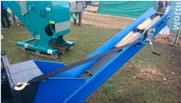
Ленточный гидравлический выводной
