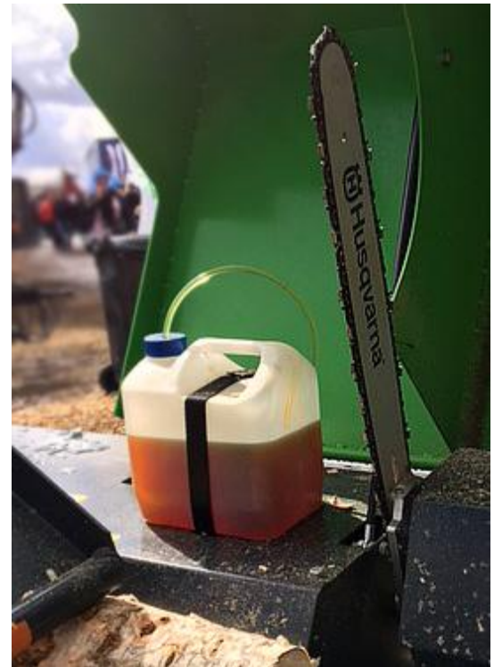
Снабжён отдельным маслобаком для смазки цепи.
