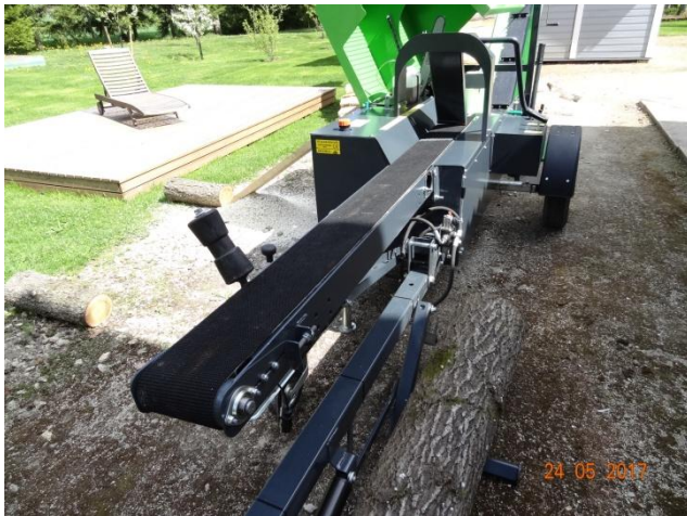
Конвейер для подачи бревна
