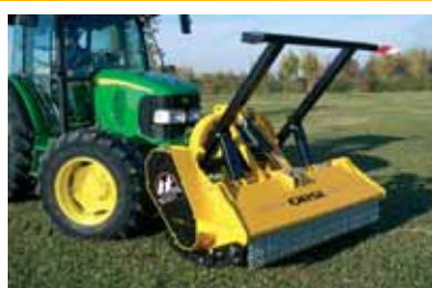
OPTIONAL: ARCO DI PROTEZIONE REGOLABILE ADJUSTABLE BUMPER SCHUTZBÜGEL ARC DE PROTECTION REGLABLE ARCO DE PROTECCION REGULABLE
